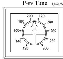
注: 为防止电机长时间超功率运行从而损坏电机, 请按照上图所示数值结合所配电机功率进行正确设定。当负载发生较大变化并导致电机实际运行功率超过设定值时, 驱动器将进入自动保护模式。
